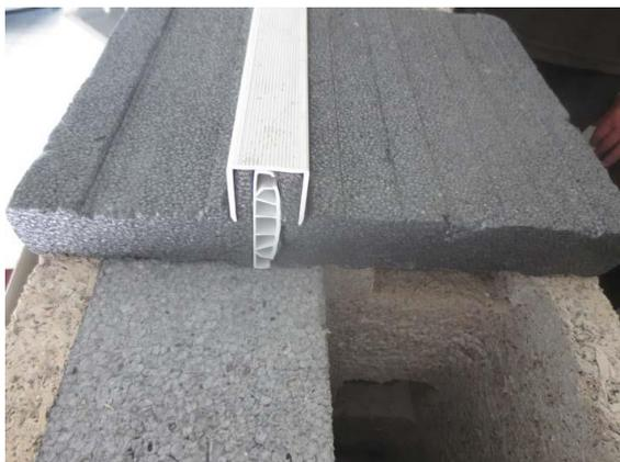
Das für den Holzmantelstein gefertigte Anchlusselement ist gedämmte und thermisch getrennt.
